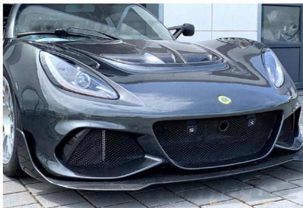
Ein Frontsplitter sorgt für einen geleiteten Luftstrom an der Fahrzeugfront zur Verbesserung der Bodenhaftung. Die Auftriebskraft wird dabei durch den entstehenden Unterdruck am Unterboden verringert und speziell bei hohen Geschwindigkeiten das Fahrzeug zusätzlich stabilisiert und das Einlenkverhalten verbessert (Downforce).
