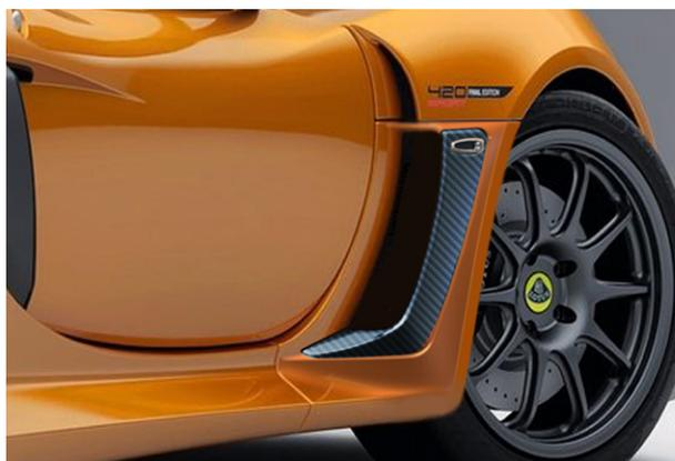
Die oberen Radhausentlüftungen senken den entstandenen Luftdruck und damit auch den Widerstand im Radhaus. Der Auftrieb des Radhauses wird durch die veränderten Druckverhältnisse minimiert und der entstehende Luftstrom sorgt gleichzeitig für verbesserte Kühlung der Bremsanlage.
