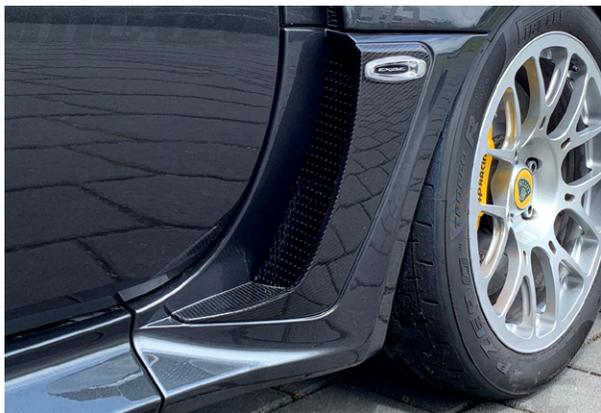
Damit die in die Radhäuser geleitete Luft sauber ausströmen kann, haben wir zusätzlich die KT-Track Carbon A-Panels entwickelt. Alle drei Bauteile können auch einzeln eingesetzt werden. Der optimale aerodynamische Effekt ergibt sich allerdings erst bei gemeinsamer Verwendung.
