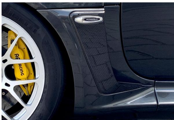
Der austretende Luftstrom legt sich um die Front des Fahrzeugs und generiert somit weiteren Anpressdruck und verbessert die Anströmung des Heckflügels.
